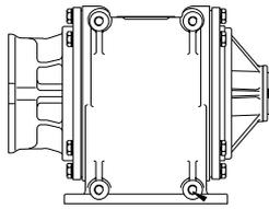
**Selbstansaugende Flügelzellenpumpe für direkt in die Welle einzusteckenden Hydraulikmotor, für dünnflüssige Mineralölprodukte und andere nicht korrosive und / oder feststofffreie Medien.**
